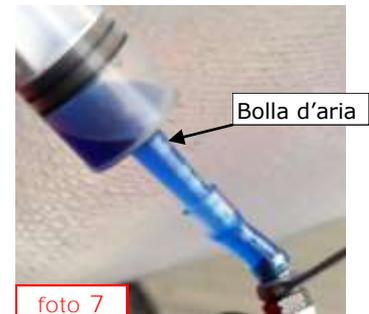
10. Azionare lentamente il pedale del freno 2 o 3 volte all'incirca. Se l'aria rimane ancora nella pompa, le bolle saliranno attraverso il condotto nella siringa **A**. (foto 8)
