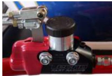
Pompa freno posteriore a pedale
