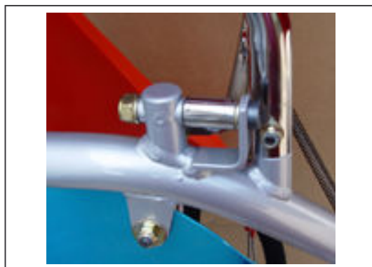
Détail de la fixation de la pédale de frein
