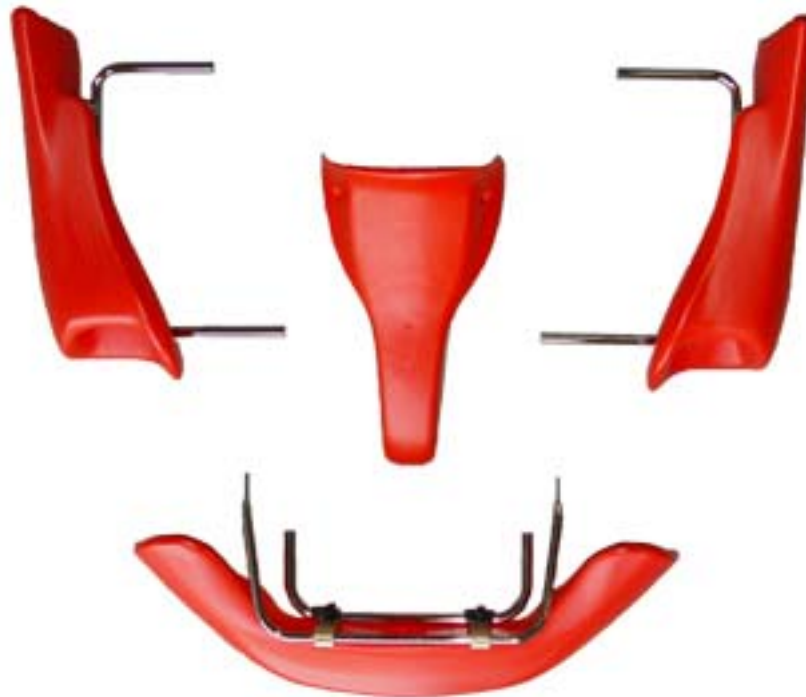
PHOTO VUE DE DESSUS DES ÉLÉMENTS DE CARROSSERIE AVEC LEURS SUPPORTS PHOTO FROM ABOVE OF BODYWORK ELEMENTS WITH THEIR SUPPORTS
